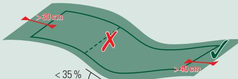
Lorsque vous posez le câble périphérique sur des pentes, respectez les distances et les inclinaisons maximales ! L'angle du câble périphérique doit se trouver sur une surface plane. Al tender el cable periférico en taludes, tener en cuenta las distancias y las inclinaciones máximas. El ángulo del cable periférico debería estar situado sobre una superficie plana.
